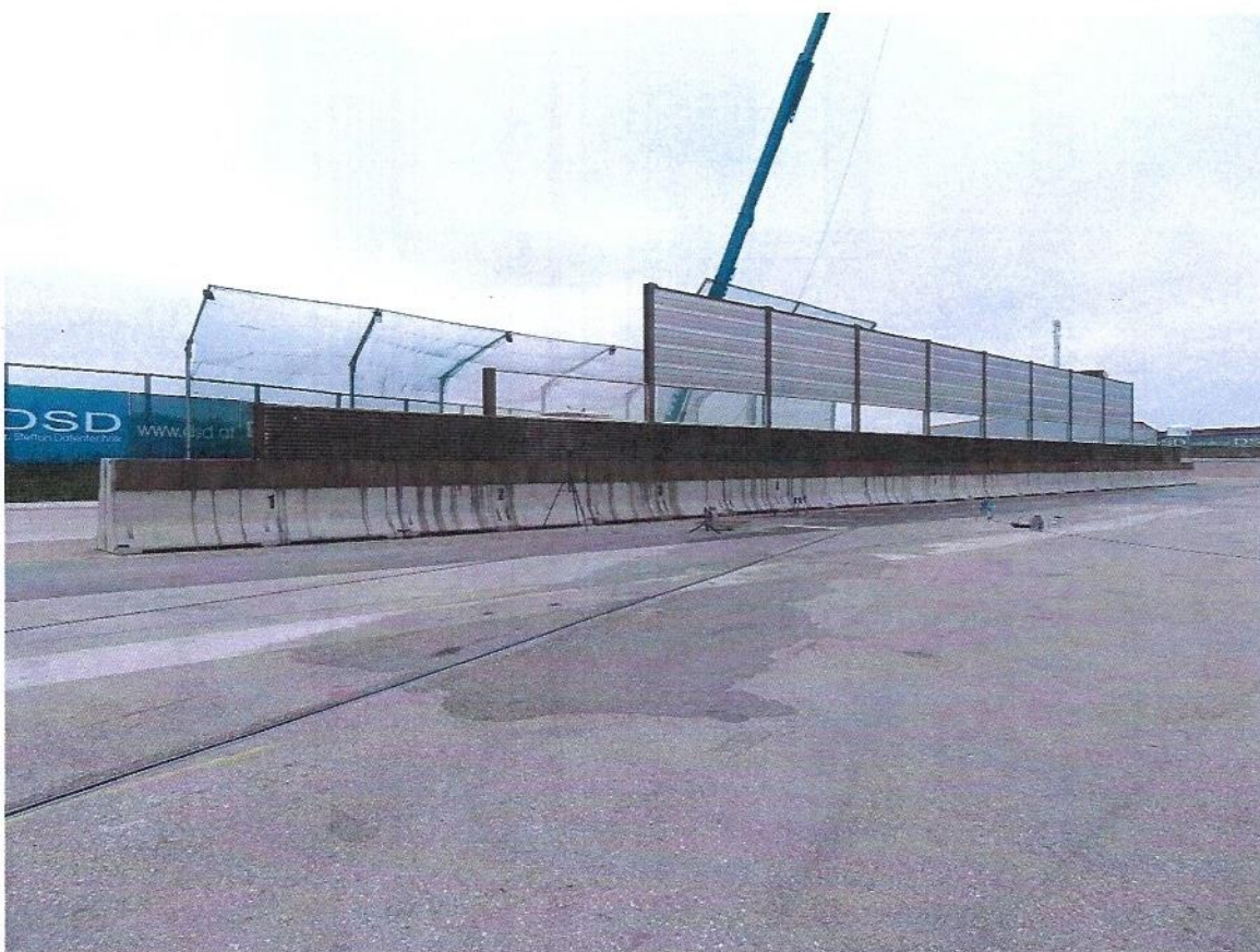
Obrázok 25 – Betónové zvodidlo NBH 150XA/600-5 alebo NBH 150XA/600-5-8A fotografia osadenia pri nárazových skúškach
